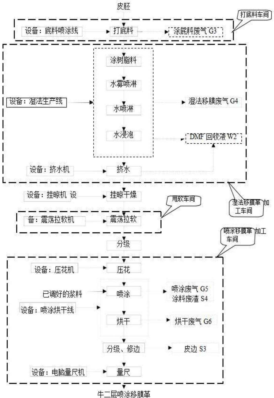
图 4-4 牛二层喷涂移膜革生产工艺流程及产污环节图
